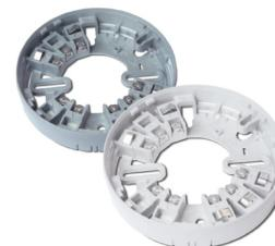
Base separata con attacco a baionetta. La base va fissata al muro o al soffitto ed i cavi vanno fatti passare nella parte centrale. Successivamente si avvia il sensore alla base, facendo attenzione al "clic" che conferma l'incastro.
